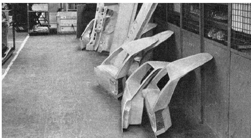
ファイバーグラス製のボディパネル、 ドア、ダッシュボード。
