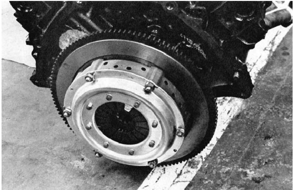
ボーグ・アンド・ベック製3プレート・クラッチ。急激なエンゲージをするのでとてもロードカーとしては使えない。
