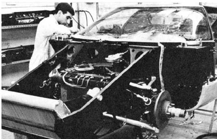
鋼製フレームに直接ウインドシールド・ガラスをプラスチック接着パテで貼りつける。100mphで衝突してもウインドシールドははがれなかったという。
