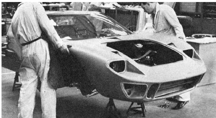
ノーズカウリングの取り付け作業。
