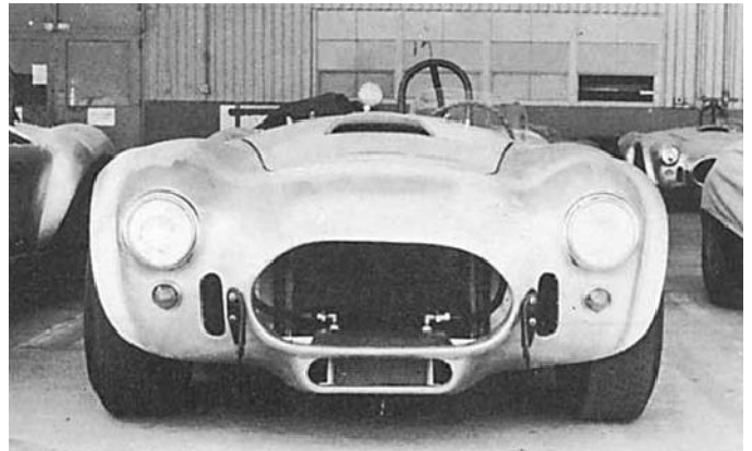
427のレーシング型。ラジエター・エア・インテークが、289よりぐっと大きくなり、両側にはブレーキ冷却ダクト、下にはオイル・クーラーの穴がある。タイヤはフロント7.50×15、リヤ9.50×15というサイズだ。
