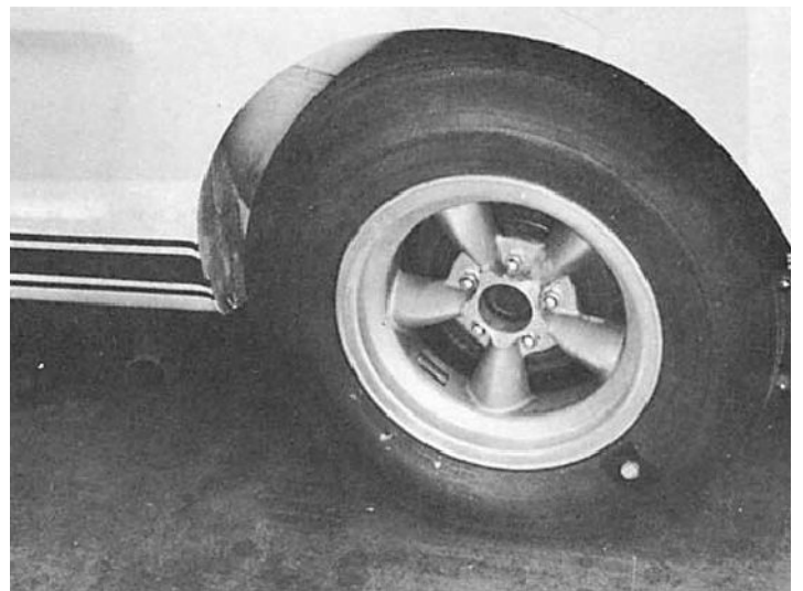
コンペティション350GTの軽合金ホイールとサイド・エグゾースト・パイプ。
