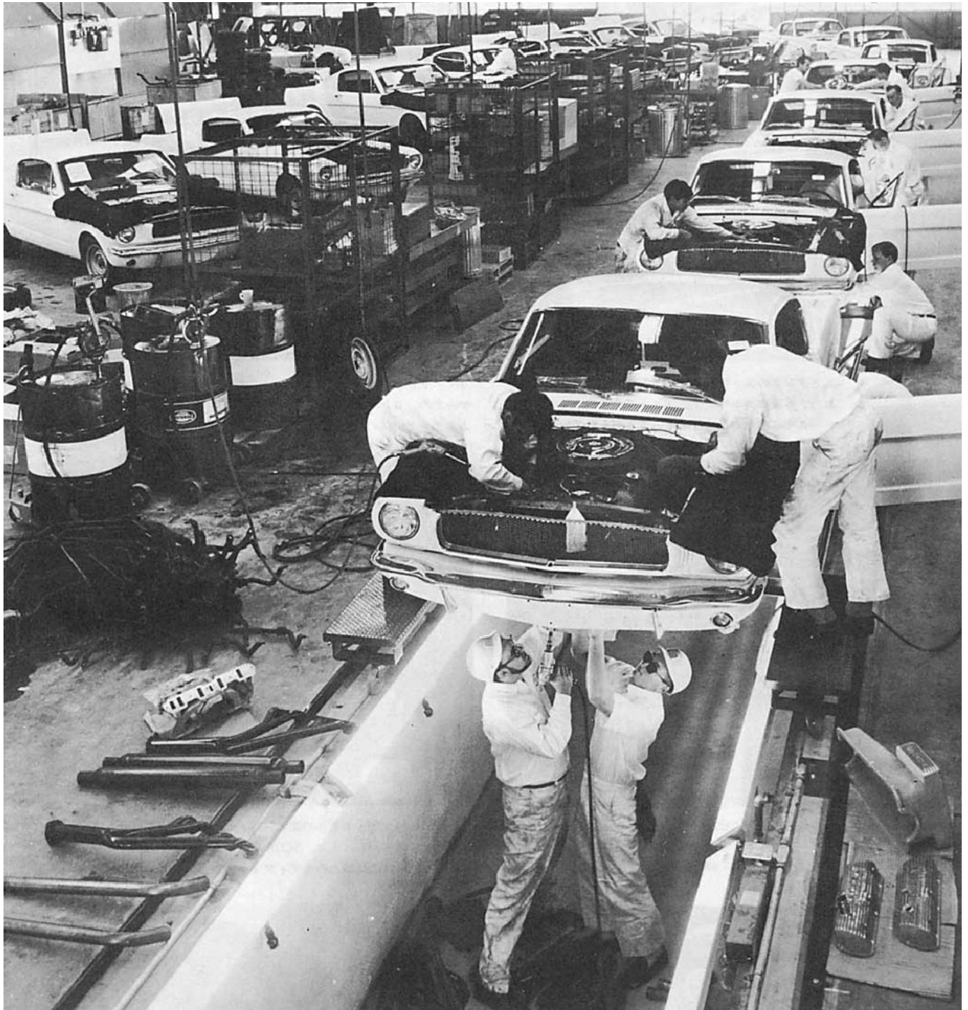
このラインでコブラ・オイルサンプ、ロッカーカバー、インテイク・マニフォールド、エキゾーストがつけられる。
