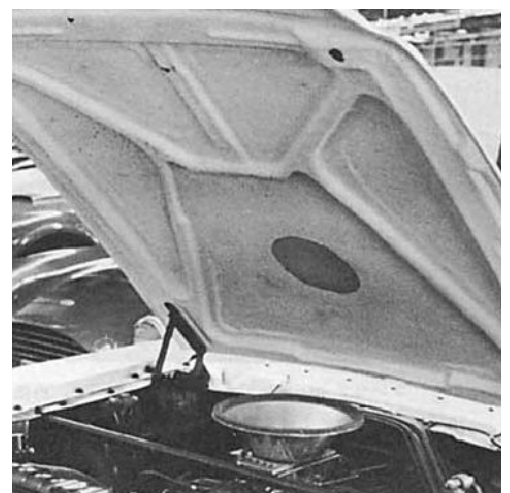
コンペティション350GTのボンネットは軽量化のためファイバーグラスでできている。
