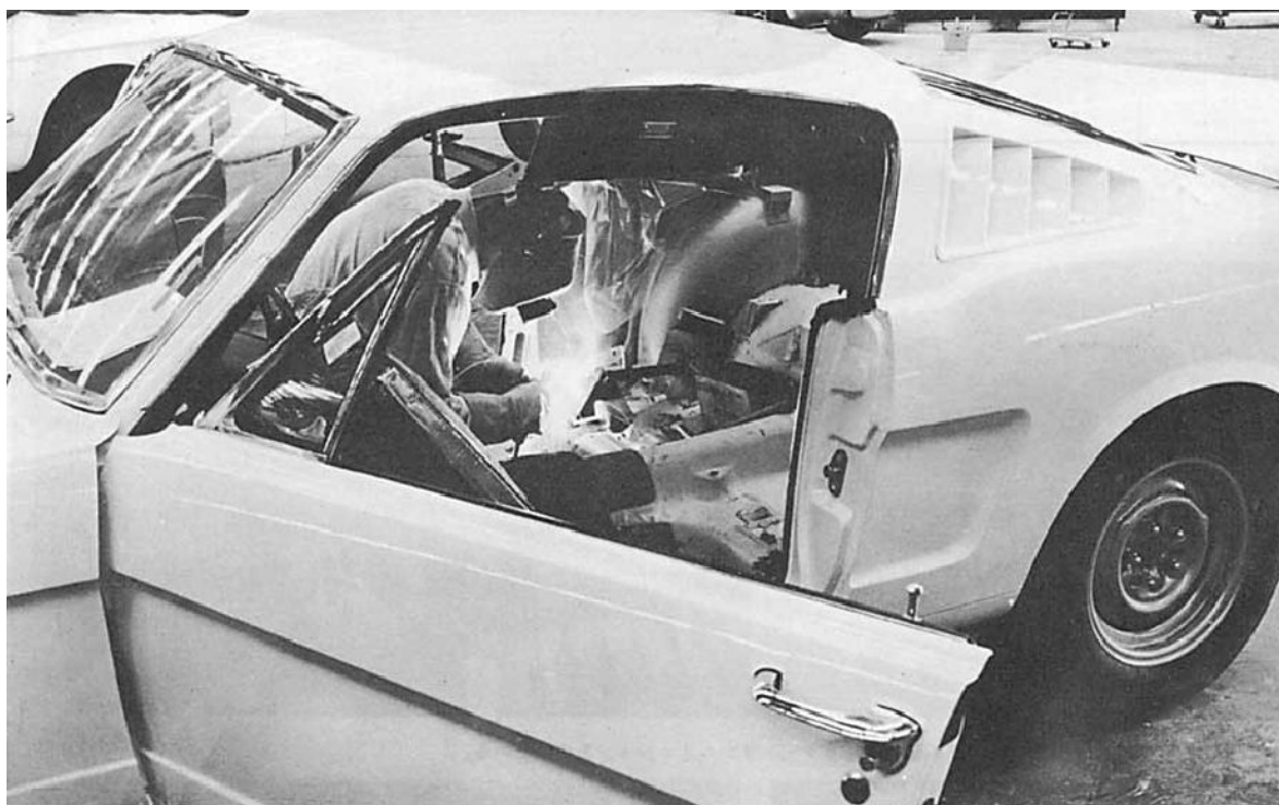
リヤ・サスペンションにラジスロッドをつけ加えている工程。2+2ボディだがリヤシートは外され2シーターとなる。
